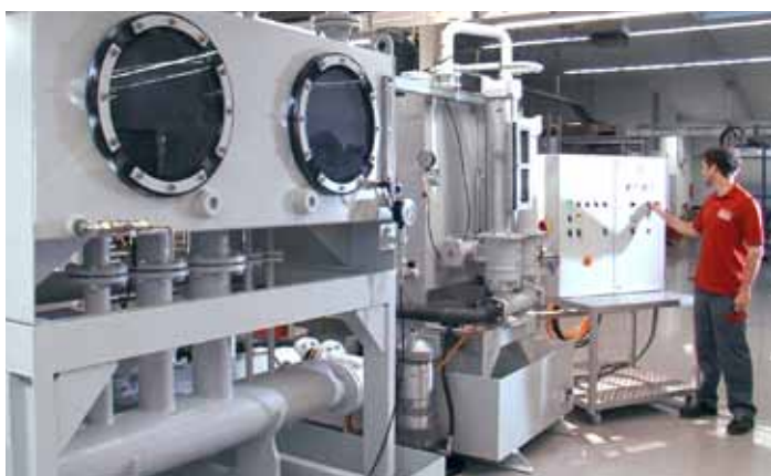
Prüfstand zur Simulation eines Trockensumpfgetriebes
