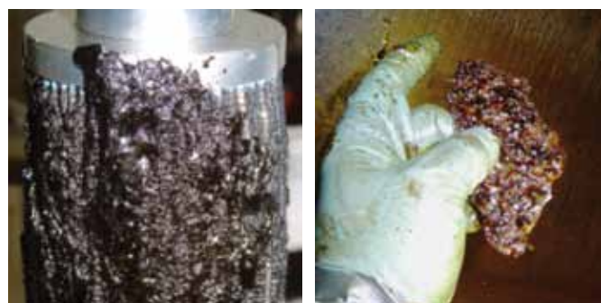
Schäden durch elektrostatische Entladung am Betriebsmedium
