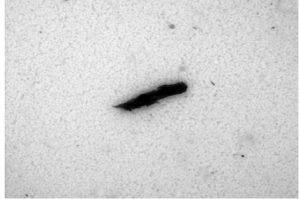
2. Größter Partikel: Nichtmetall Länge: 269 µm Breite: 58 µm
