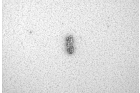
2. Größter Partikel aus 4. Beprobung: Metall Länge: 152 µm Breite: 52 µm
