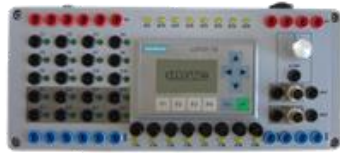
Schaltbox mit Siemens Logo Steuerung Switch box with Siemens logo PLC
