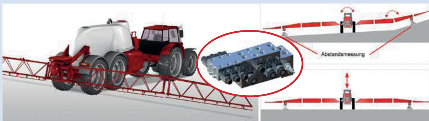
01 Hanglagen- und Distanzregelung eines Spritzgestänges mithilfe von Ultraschall-Abstandssensoren und einer hochdynamischen Ventil- und Regeltechnik
